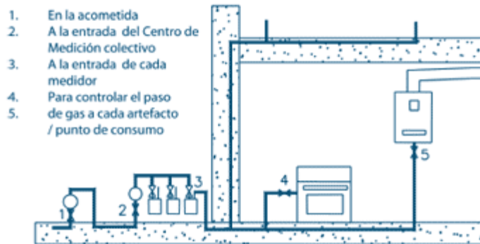
⌘ Válvulas de corte
