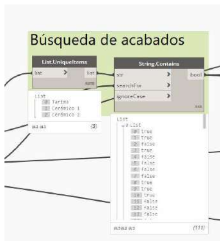
Fig. 12. Programación para la búsqueda de los acabados del solado del archivo “Suelos_Param.dyn”.
