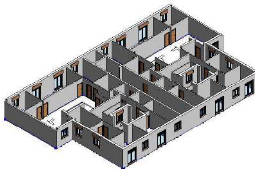
Fig. 6.5 Resultado de ejecutar el archivo "DWG a RVT.dyn" para muros de 10, 20 y 30 cm en Revit.
