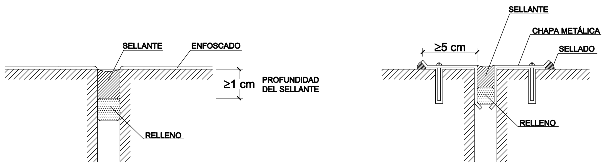
Figura 2.6 Ejemplos de juntas de dilatación
