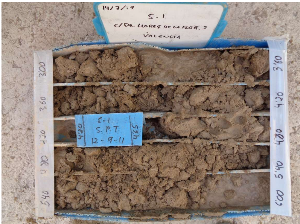
Foto 6. Sondeo 1, testigo de muestra entre 3,0 y 6,0 metros de profundidad
