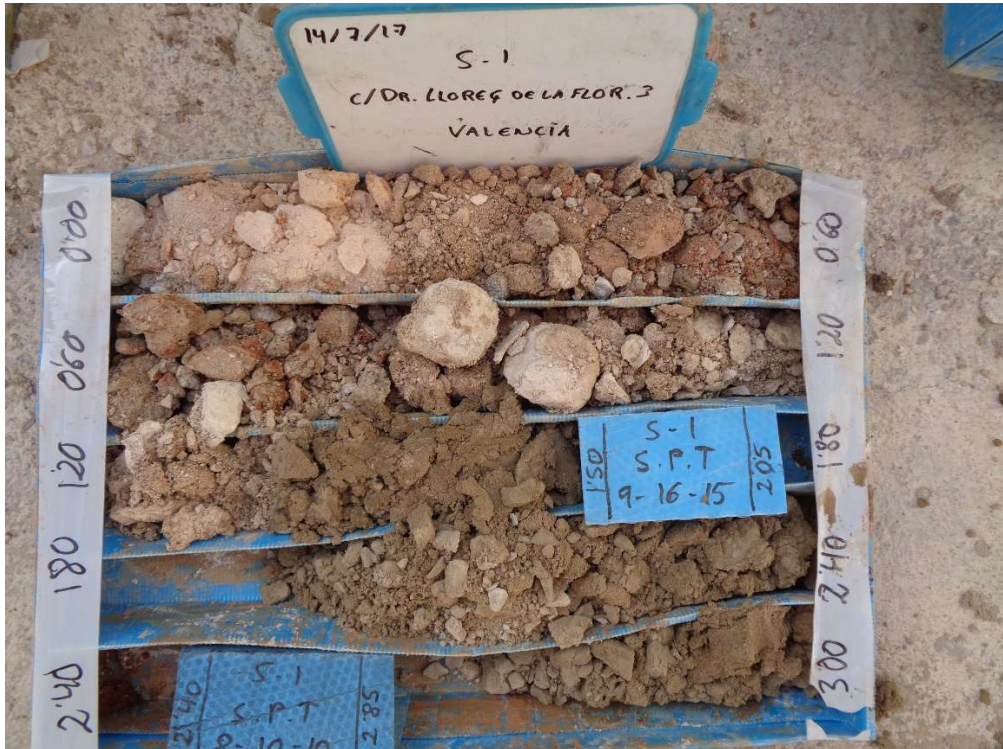
Foto 5. Sondeo 1. Testigo de muestra entre 0,0 y 3,0 metros de profundidad
