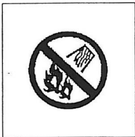
Prohibido apagar con agua
