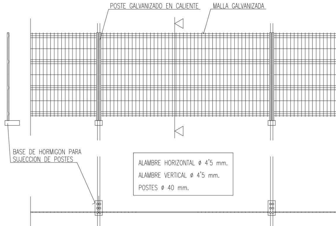
LAS UNIONES ENTRE POSTES SE REALIZARA MEDIANTE ACCESORIOS DE FIJACION INCORPORADOS
