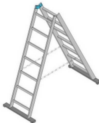
ESCALERA AUTO-ESTABLE CON PELDAÑOS EN LOS DOS TRAMOS CON LARGUEROS PARALELOS Y EQUIPADOS CON ESTABILIZADORES FUJOS EN LA PARTE INFERIOR DE CADA TRAMO.
